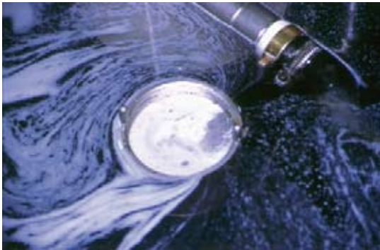
Die Ölfilme folgen dem hydraulischen Gradienten und können separiert werden.
