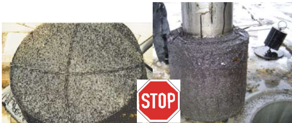
Beispiel verstopfter Koaleszenzmaterialien herkömmlicher Koaleszenzabscheider
